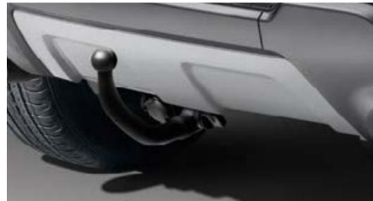
Enganche de remolque desmontable
