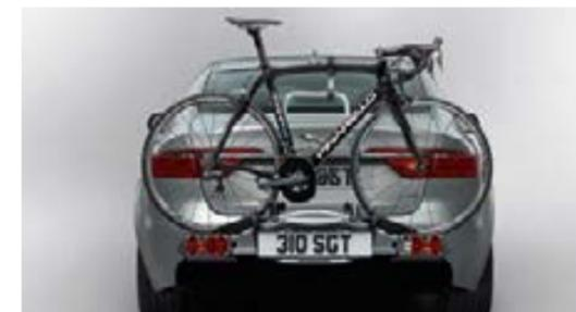
**Portabicicletas montado en el enganche de remolque**
