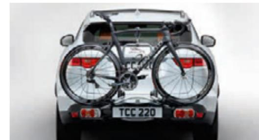
**Soporte para bicicletas montado en el enganche de remolque**
